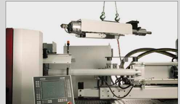
Schneller Schnecken- und Zylinderaustausch für neue Produktionsaufgaben
