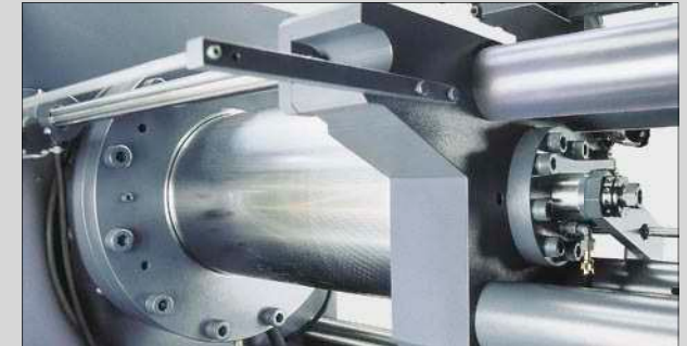
Zentraler hydraulischer Schließzylinder mit leicht zugänglichem Zentralauswerfer
