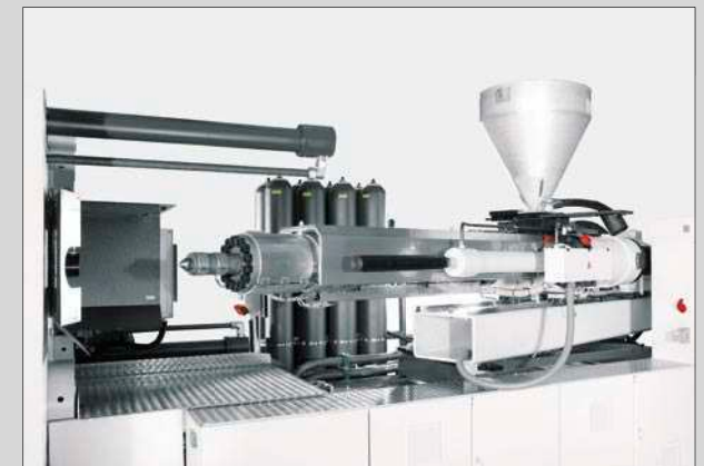
Die gesamte Spritzeinheit lässt sich für Wartungsarbeiten ausschwenken
