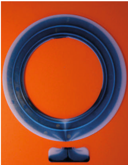
Bild 7. Nebenkavitäten lassen die Kernkomponente in die beabsichtigten Kavitätenbereiche fließen (Foto: Kraft)
