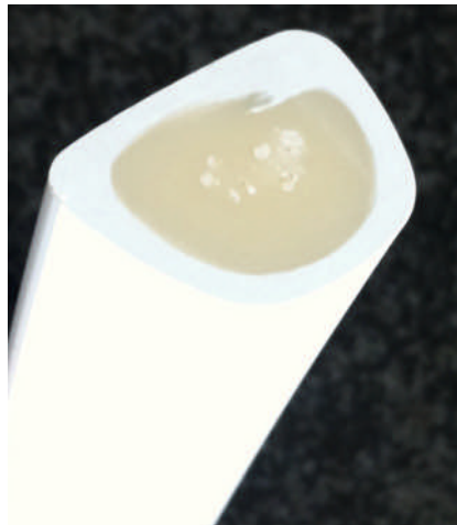
Bild 4. Ein glasfaserverstärkter Kern unter einer Außenhaut aus ASA verleiht diesem Griff seine Stabilität (Foto: Weber Werkzeugbau)
