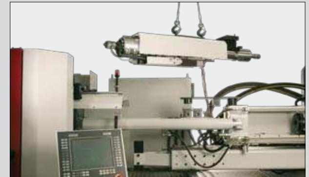
Schneller Schnecken- und Zylinderaustausch für neue Produktionsaufgaben
