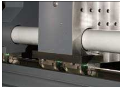
Groß dimensionierte Linearführungen für die bewegliche Werkzeugaufspannplatte sichern eine exakte Führung auch bei schweren Werkzeugen
