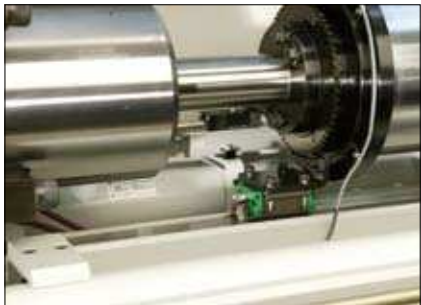
Die Abstützung des drehenden Spritzkolbens gewährleistet die hochpräzise Führung und den exakten Rundlauf der Schnecke
